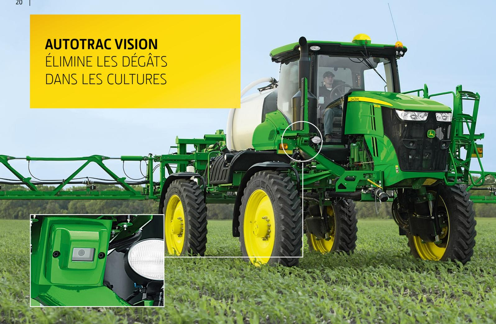
AutoTrac Vision\* utilise une caméra montée à l'avant pour voir tôt dans la saison le blé, le soja et le coton à une hauteur d'au moins 10 cm à 15 cm. Ce système de guidage maintient les roues du pulvérisateur au centre de chaque rangée et réduit les dommages nuisant au rendement de la récolte, même si la dérive du semoir crée un mauvais alignement, ou si la ligne de guidage découlant de la plantation n'est pas disponible pour la pulvérisation.
