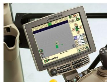
Pendant son attente en bordure d'un champ, le conducteur d'un tracteur peut visualiser sur l'écran de sa console la position exacte dans la parcelle des autres tracteurs et moissonneuses-batteuses, ainsi que le niveau de remplissage de la trémie à grain de ces dernières.
